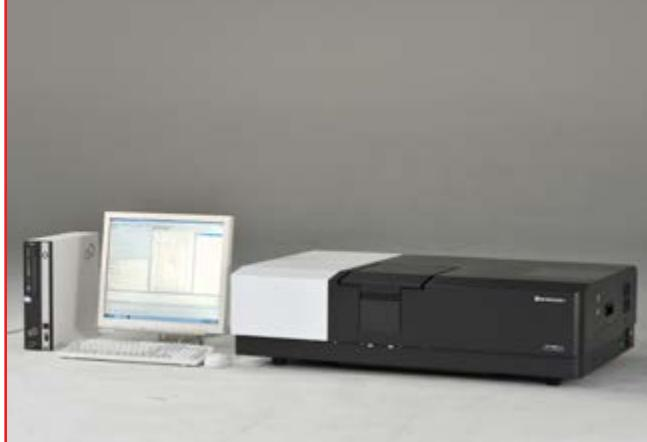
Фото № 4. Спектрометр UV-3600Plus
