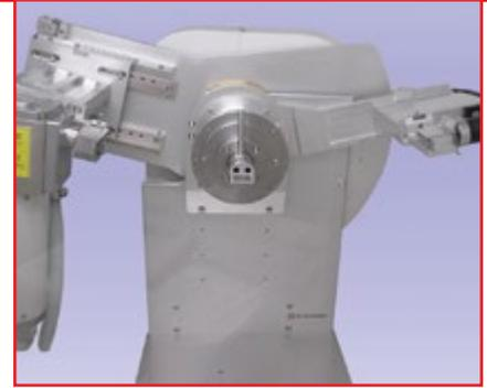
Фото № 3. Вертикальный гониометр  $\theta$ - $2\theta$  типа для рентгеновского дифрактометра модели XRD-7000 «Maxima\_X»
