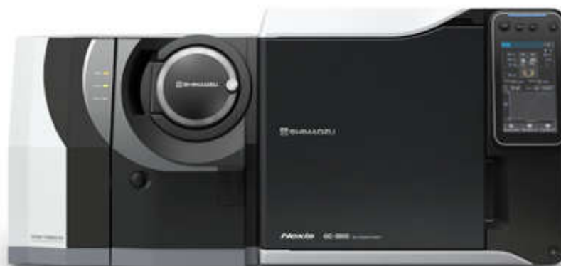
Фото 4. Газовый хромато-масс-спектрометр с тройным квадруполом модели GCMS-TQ8050NX
