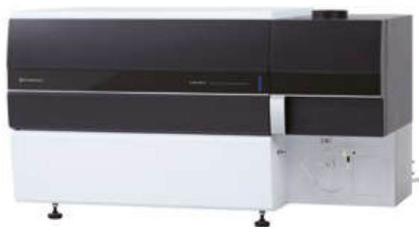
Фото 8. Атомно-эмиссионный ИСП-спектрометр модели ICPE-9810
