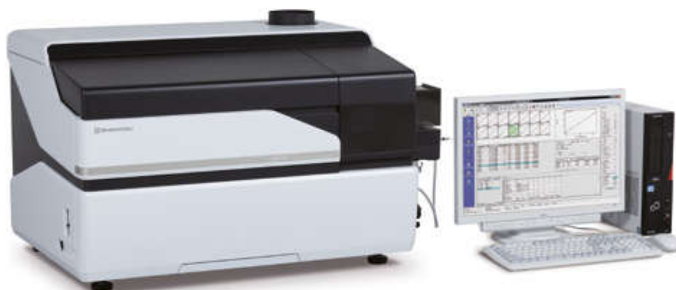
Фото 9. ИСП-масс-спектрометр модели ICPMS-2030
