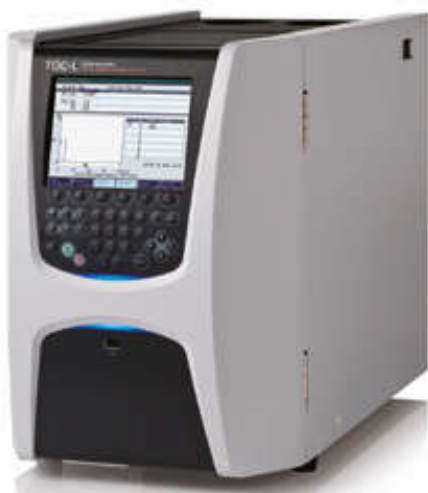
Фото 1. ТОС-анализатор модели ТОС-L
