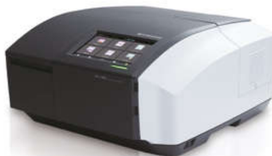
Фото 6. Спектрофотометр УФ-видимого диапазона модели UV-1900
